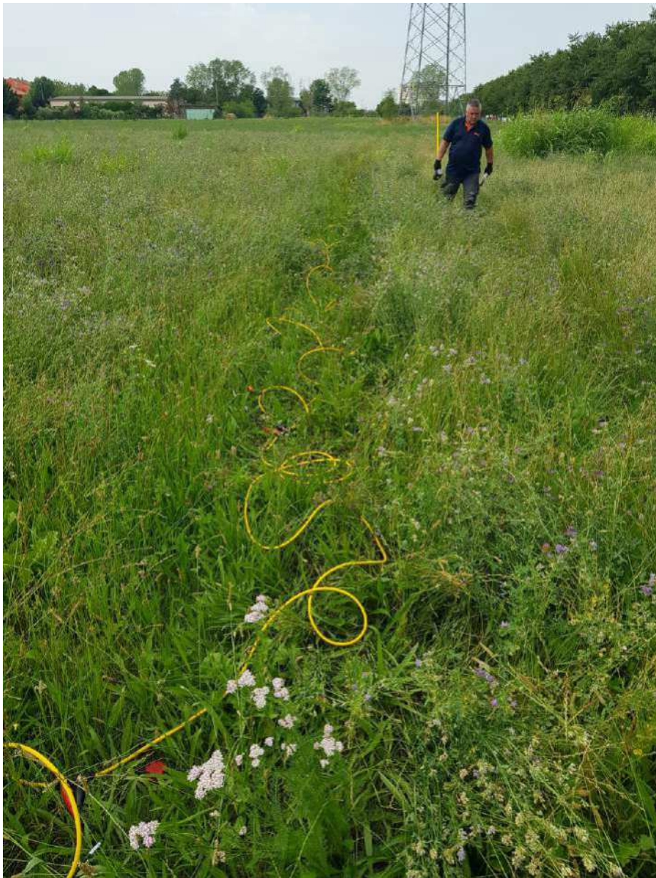
FOTO 7: Particolare dello stendimento di geofisica.
